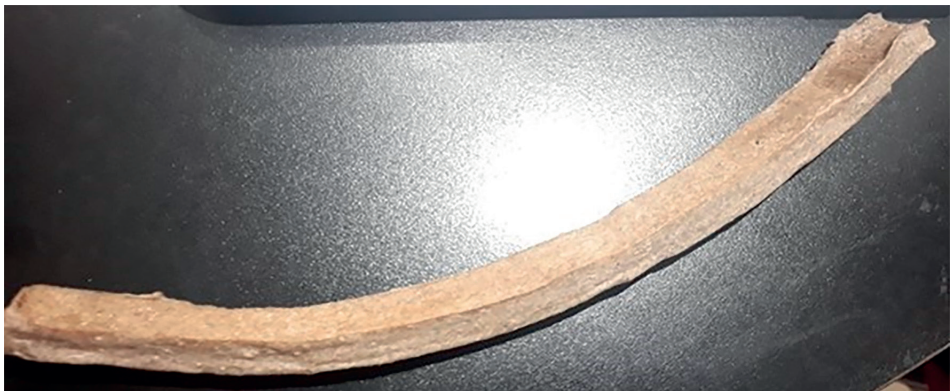
Figura 1. Probeta de caucho con refuerzo de cascarilla de semilla de caucho. Fuente: elaboración propia.
