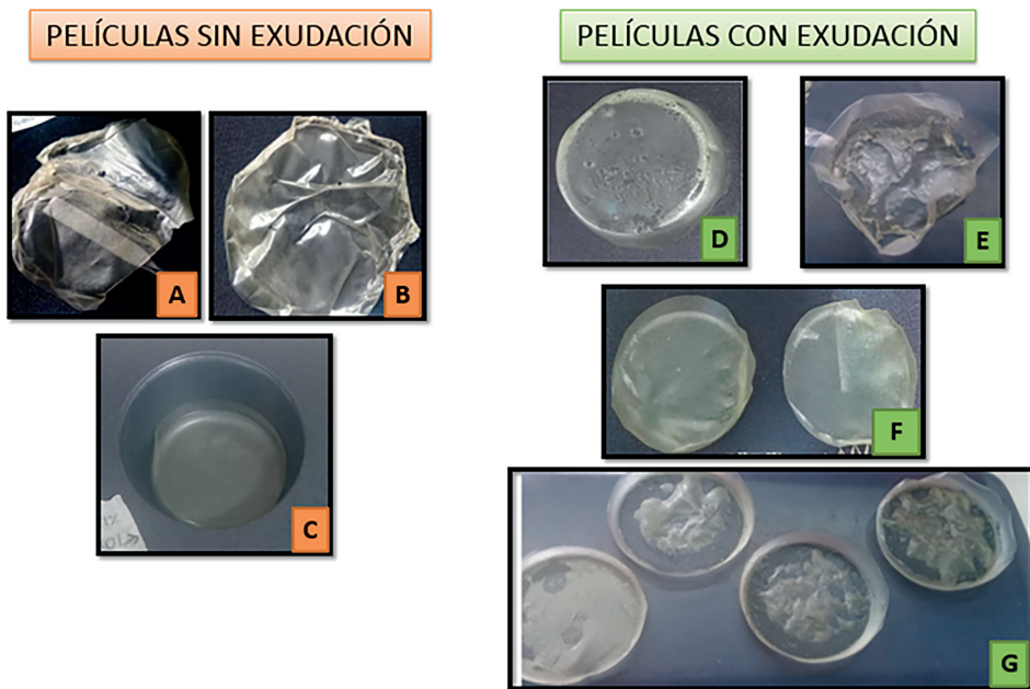
Figura 5. Fenómeno de exudación. Fuente: elaboración propia.
