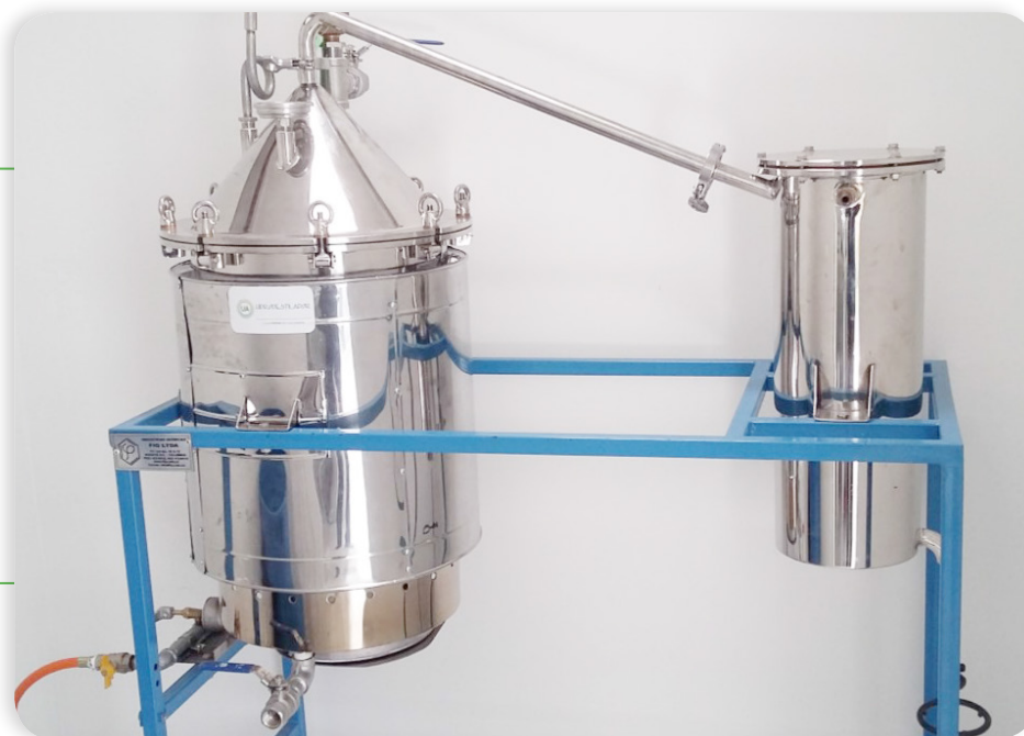
Planta piloto para la extracción de aceites esenciales. Fundación Universitaria Agraria de Colombia - UNIAGRARIA.
