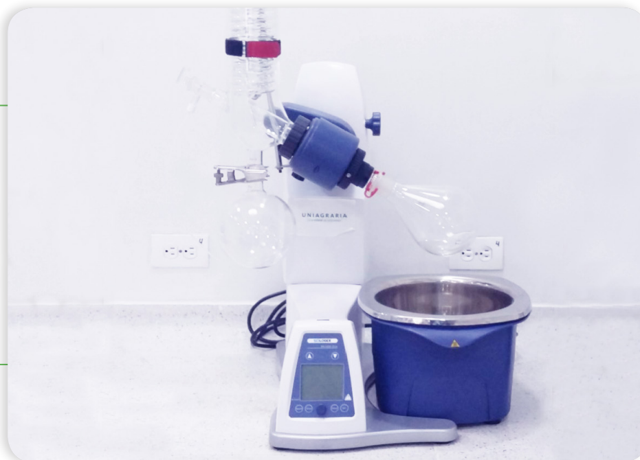
Equipo de destilación por rotavapor - Laboratorio de Ingredientes naturales. Fundación Universitaria Agraria de Colombia - UNIAGRARIA.
