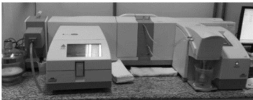
**Gráfico 3.** Equipo de difracción láser para análisis de granulometría cemento, metacaolín y ceniza volante (Villate Diaz, 2016).
