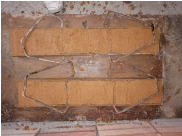
Figura 9. Moldeado de ladrillos, mezcla húmeda
