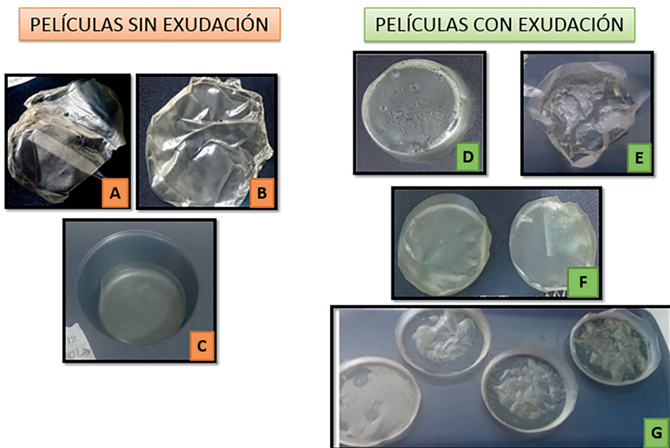
Figura 5. Fenómeno de exudación. Fuente: elaboración propia.
