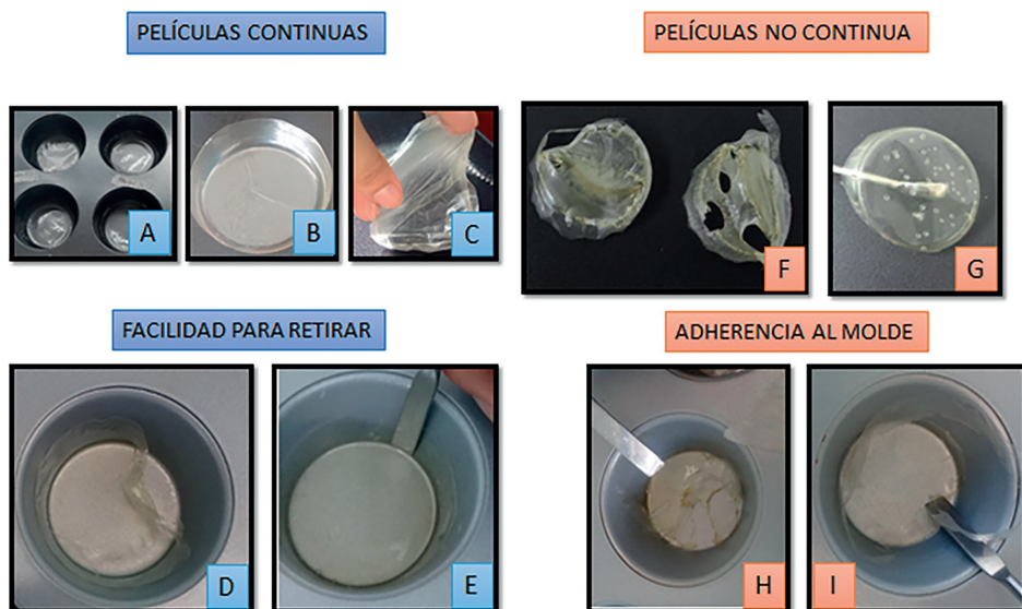
Figura 2. Capacidad de formación homogénea en el molde y facilidad para retirar.
