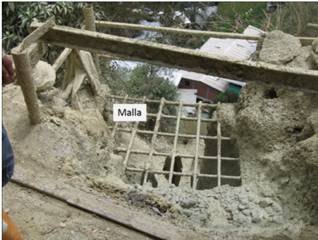
Figura 3. Malla 20x20 cm para el paso del material con mayor porcentaje de oro.
