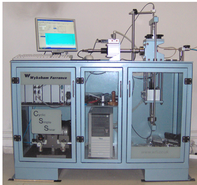
Figura 5. Equipo de corte simple cíclico fabricado Wykeham Farrance de Inglaterra.
