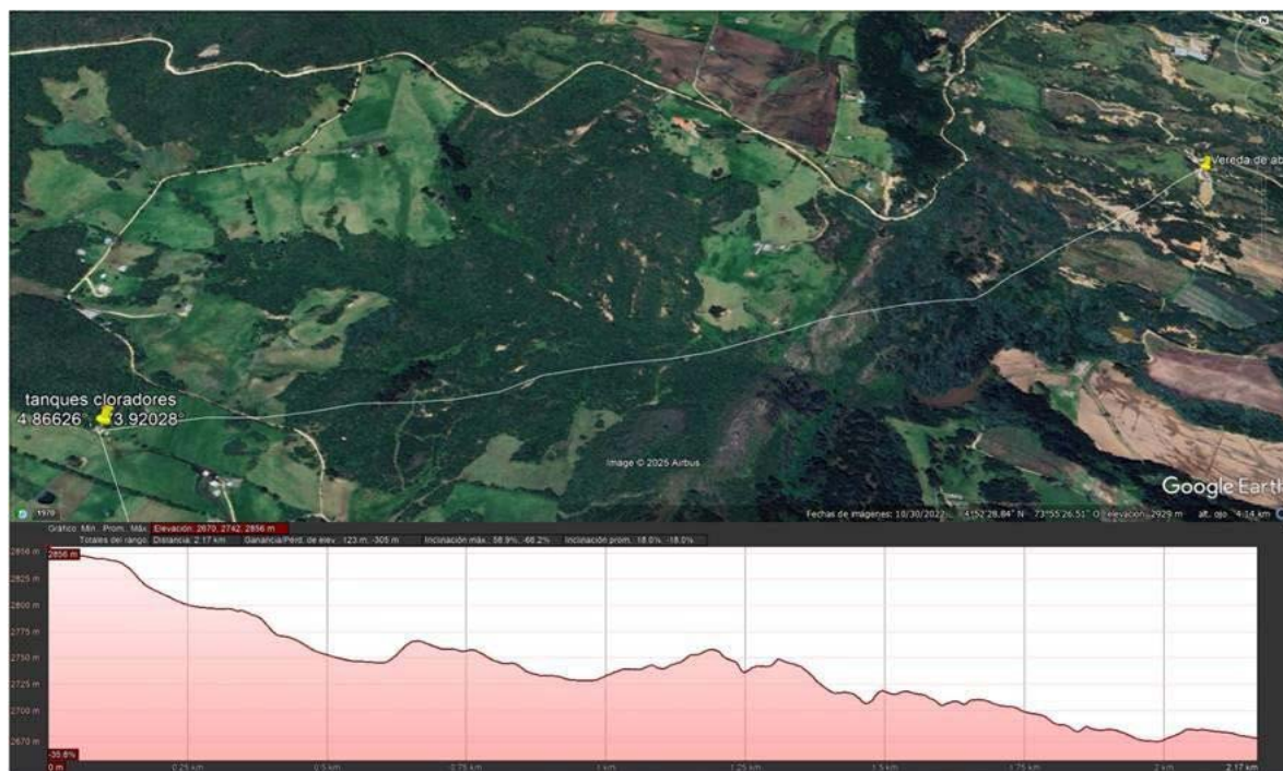
Figura 8. Perfil de elevación ruta 3, tanque clorador - vereda.
